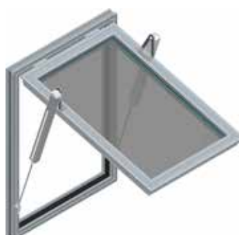
Rys. 59 Okno oddymiające mcr OSO THERM 75 z dwoma siłownikami wrzecionowymi G z przesuniętym punktem obrotu
